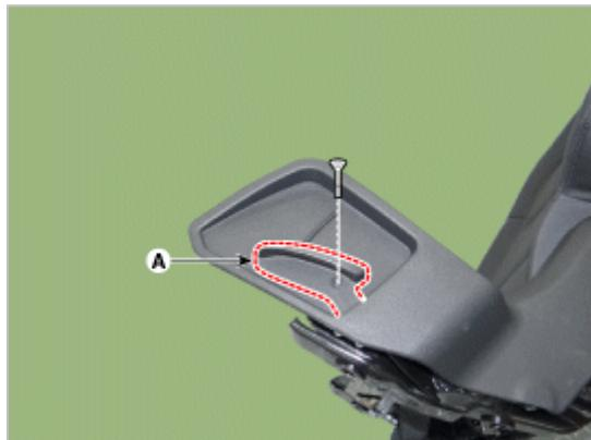
4. 拧下固定螺钉，并拆卸后座椅外侧保护盖(A)。
